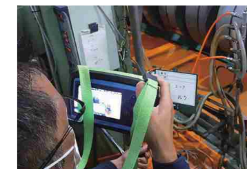
エア漏れ検査
