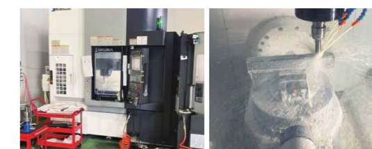
6パレット付き5軸マシニングセンタ。製品精度が向上した
