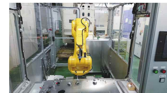
自社開発したバリ取りロボットで作業時間大幅短縮、品質向上
