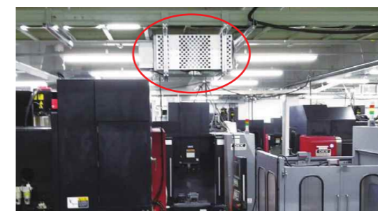
安心安全な製造現場づくりのため自社開発したミスト集塵機
