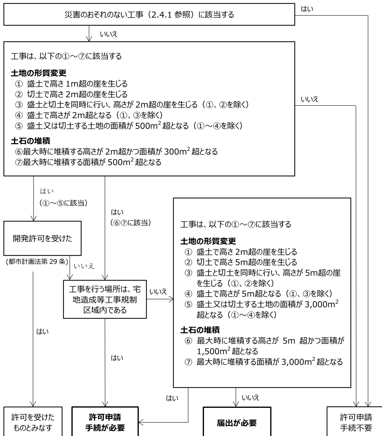
図 2-1 盛土規制法に基づく許可の要否判定フロー
