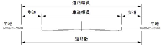
② U型側溝設置の場合（溝蓋なし）
