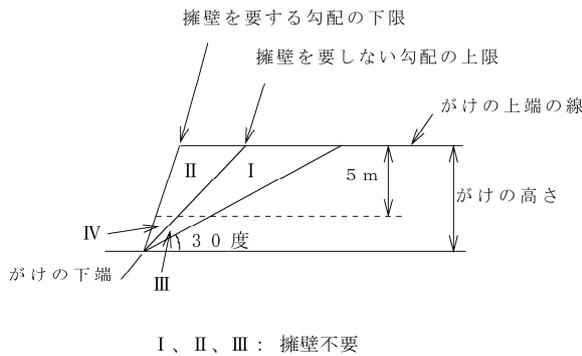
(6) 「第1号のがけ部分により2号のがけが上下に分離された場合」(規則第23条第1項第2号)
