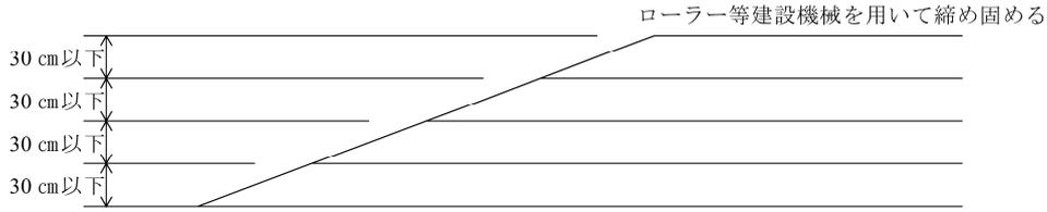
(4) 「傾斜している土地に盛土する場合の段切りその他の措置」(令第28条第5号)
