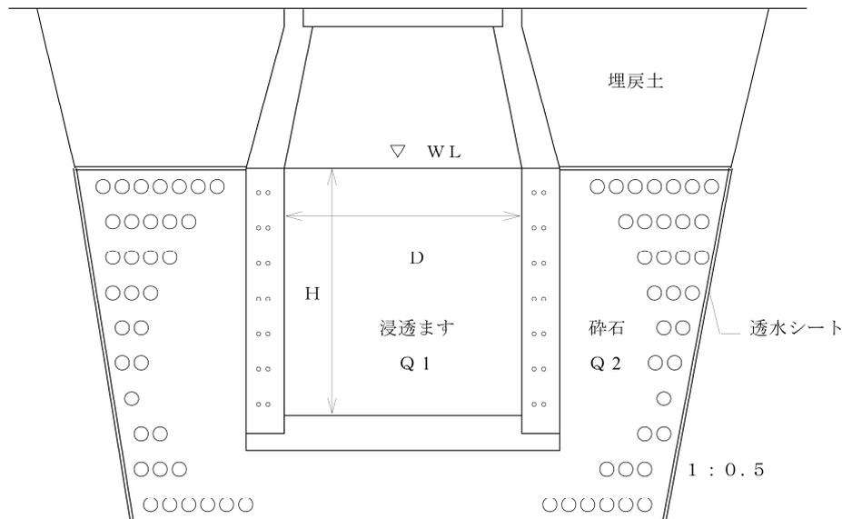
※ 貯留容量Qは、浸透ます容量Q1と砕石容量Q2の25%を加算した容量である。
