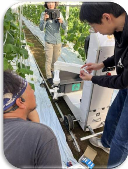
概要) AGRIST(株)から生産者ハウス設置用の自動収穫ロボットを搬入/搬入したロボットを組み立てた後、設置済みの走行用レール上を試験走行/1列2本のレールの間の本来の通路部分の土が盛り上がっている箇所、車輪が空転し走行できない状態に/確認の結果、レール走行用車輪の間の本体下にある地上走行用車輪が盛り上がった土に乗り上げていることを原因として確認/該当箇所の土を掘り低くすることで解消/側枝の収穫が開始となる実運用までの期間で何度か往復走行させ同様箇所がないか生産者で確認することを依頼/不足部品は別途送付また来場し設置
