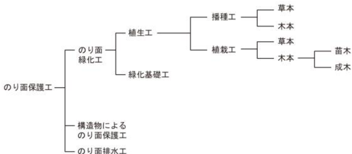
図 11-1 法面保護工の分類
