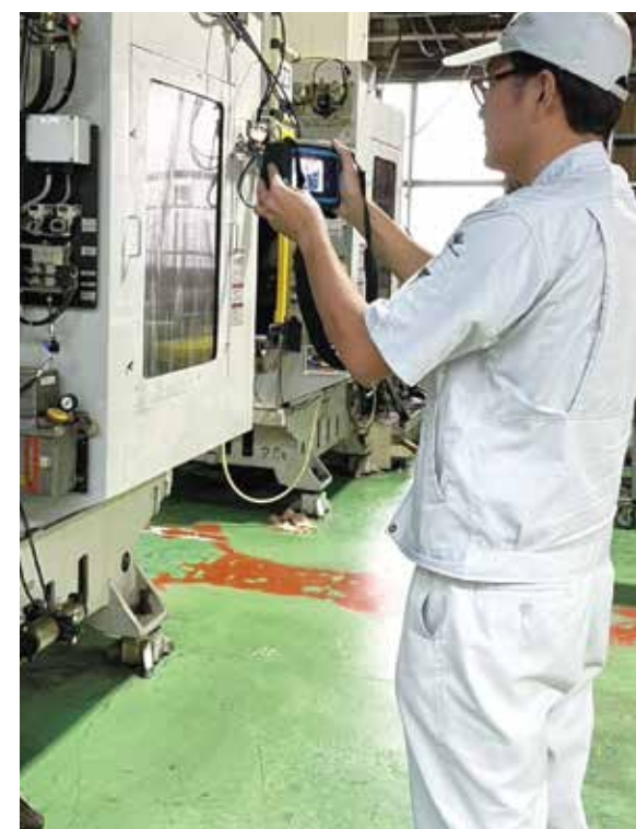
エアー漏れ調査
