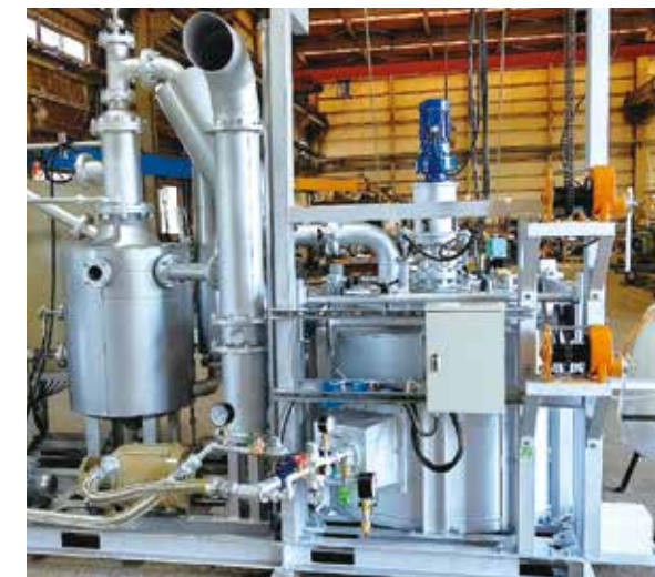
熱分解処理装置
