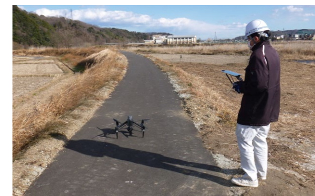
ドローンによる空撮測量イメージ
