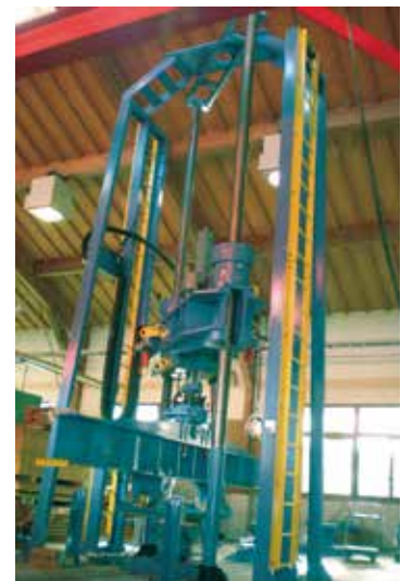
図-1 実大強度試験機
