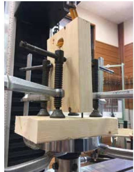
釘引き抜き強度測定の様子
