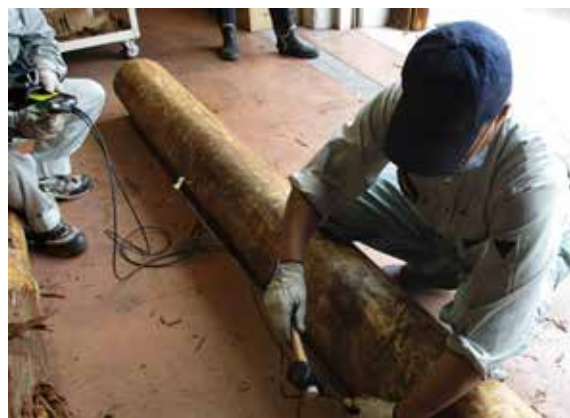
応力波伝播速度測定機による素材丸太の測定状況
