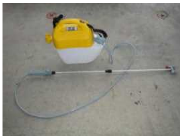
図-10 乾電池式噴霧器
