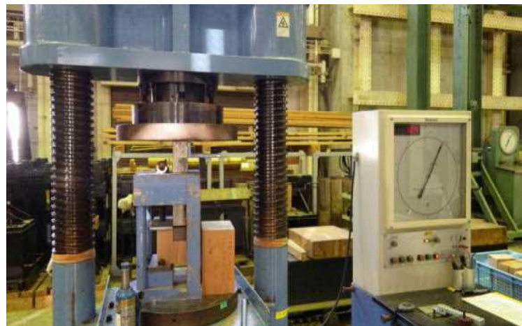
図-8 実大せん断強度試験
