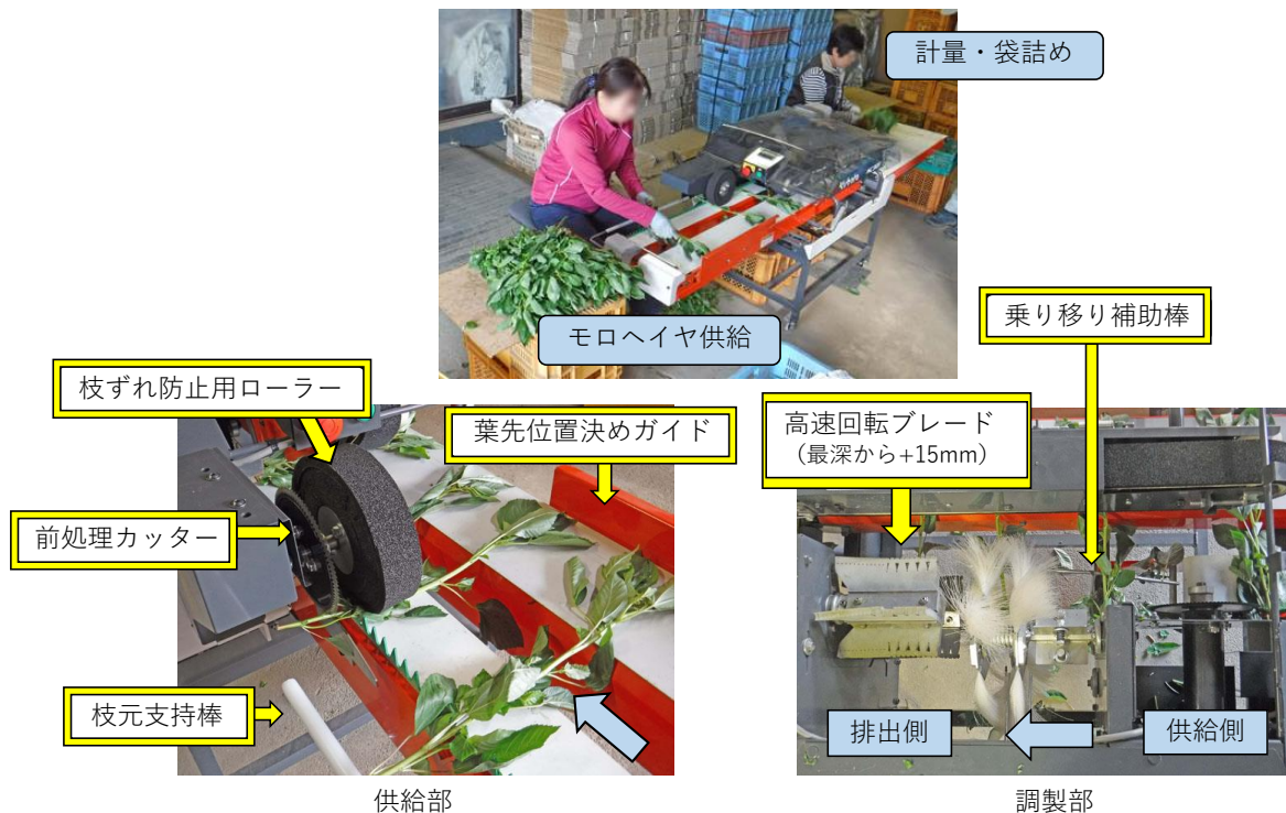
図 3 軟弱野菜調製機によるモロヘイヤ調製作業の様子 (上) とモロヘイヤ調製用アタッチメント一式 (下)
