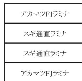
図-3 スギ・アカマツ集成材の断面構成
