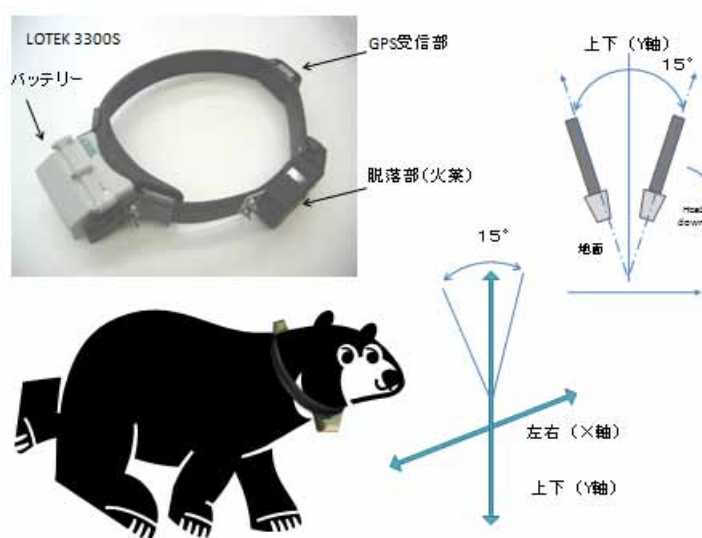
図-2 GPS首輪写真及び活動量センサー詳細図
