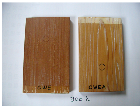
図-1 ウエザリング 300 時間後の塗膜
