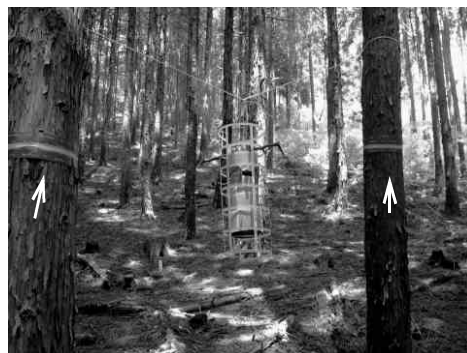
矢印；粘着バンド、中央：円筒誘引器 図-1 調査地内に設置したトラップ
