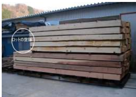
図-7 工場機におけるロットの空隙
