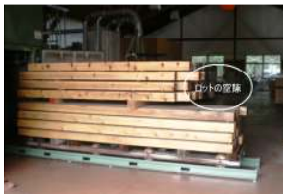
図-8 実験機に設定したロットの空隙
