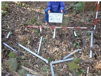
横ボーリング破損
