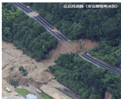
図7 土砂災害による国道・鉄道の寸断（平成30年7月豪雨、広島県）
