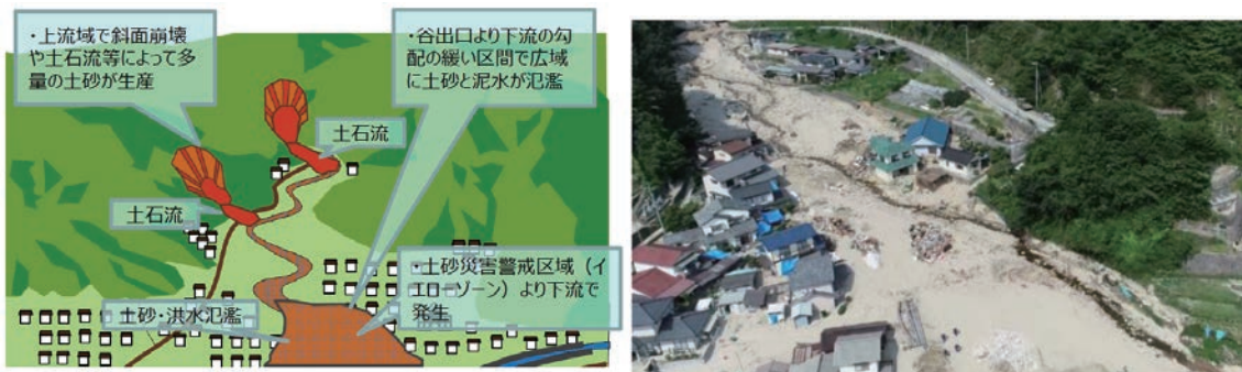
図 4 土砂洪水氾濫による被害の特徴と発生状況（平成 30 年 7 月豪雨、広島県安芸郡坂町）
