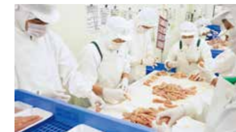
■鶏ささみの筋取り作業 食品加工工場の現場では、複数人でグループを構成し、流れ作業で鶏ささみの筋取りを行います。
