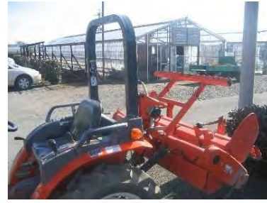
○ 安全フレームの使用
