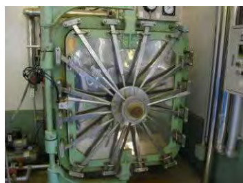
高圧釜は定期点検が義務
