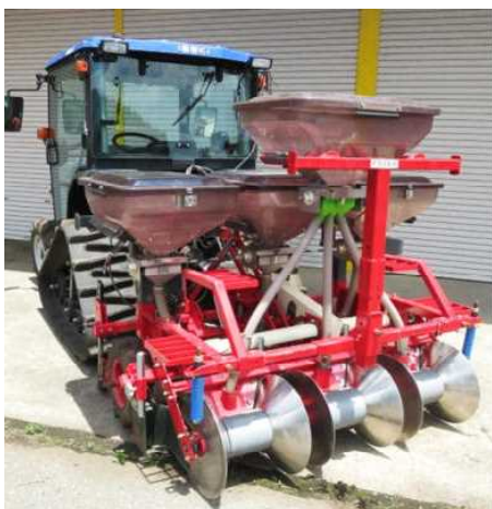
夏秋キャベツ栽培における二段局所施肥の対応した新型三兼ライムソウ（令和2年）
