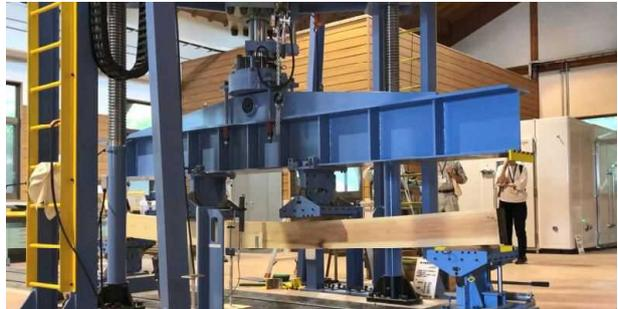
実大強度試験機による試験状況
