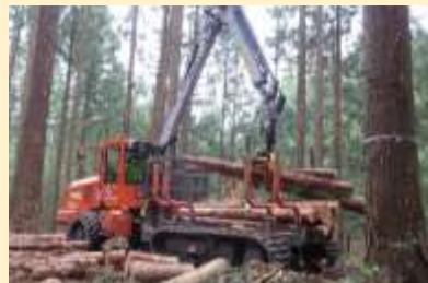
この低コスト作業システムは、ロングリーチハーベスターと走行性に優れたフォワーダ(F801)による2体制の作業システム。作業道を高密度（緩傾斜地では250m/ha程度）に作設し、ロングリーチハーベスターの直伐り・直取りでの作業範囲を確保し、人力での作業を抑える工夫をしている。
