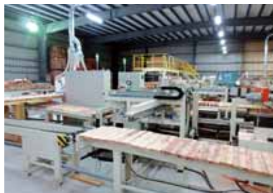
写真：集成材ラミナ製造
