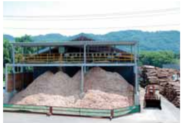
写真：C材利用によるチップ生産（渋川県産材センター）
