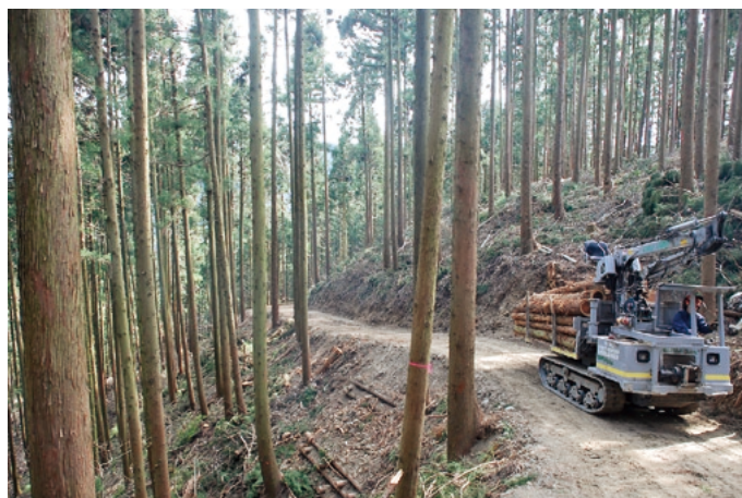
写真：作業道を利用した木材の搬出
