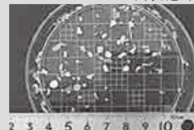
微細なプラスチック片 (中央環境審議会循環型社会部会プラスチック資源循環戦略小委員会（第1回）資料から)
