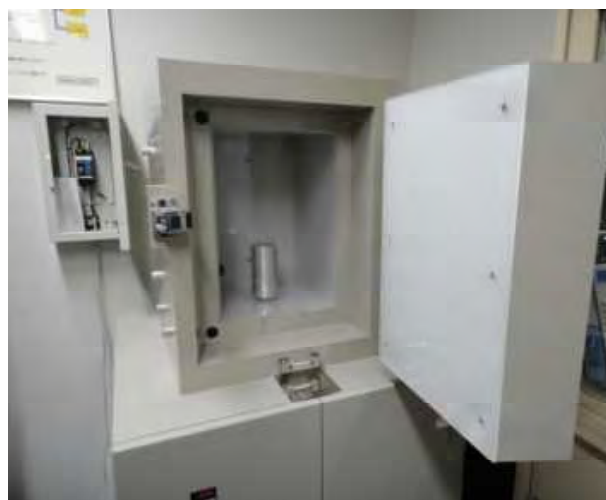
ゲルマニウム半導体検出器（食品等の放射性物質濃度を測定します）
