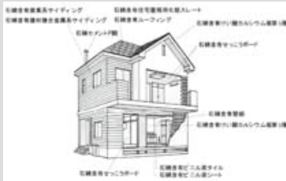
図1 アスベスト含有建材の使用部位例（出典：国土交通省目で見えるアスベスト建材（第2版））
