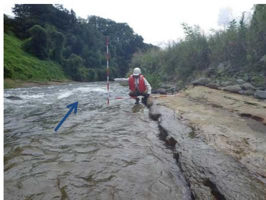
図 2.5 河床洗掘箇所
