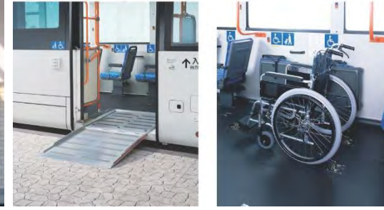
ノンステップバスと車椅子スペースの イメージ（日産HP）
