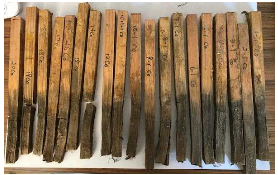
図-3 腐朽促進試験開始後18ヶ月の無処理材
