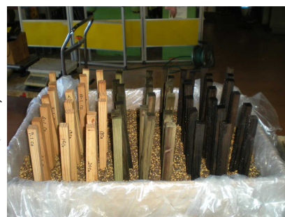
図-1 ファンガスセラー試験
