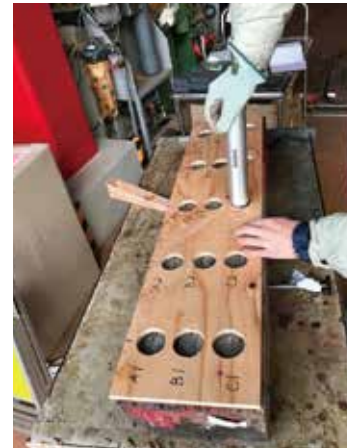
図-1 打込貫入試験
