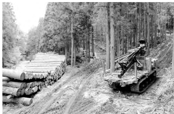
作業道を利用した木材の集積作業
